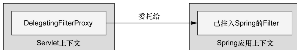
图9.1 DelegatingFilterProxy把Filter的处理逻辑委托给Spring应用上下文中所定义的一个代理Filter bean
